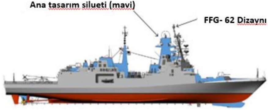
Şekil 3: FFG 62 Tasarımında Ana Tasarımdan Yapılan Değişikliklerin Gösterimi
